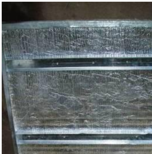
El marco del colector montado a la plancha con espaciadores
